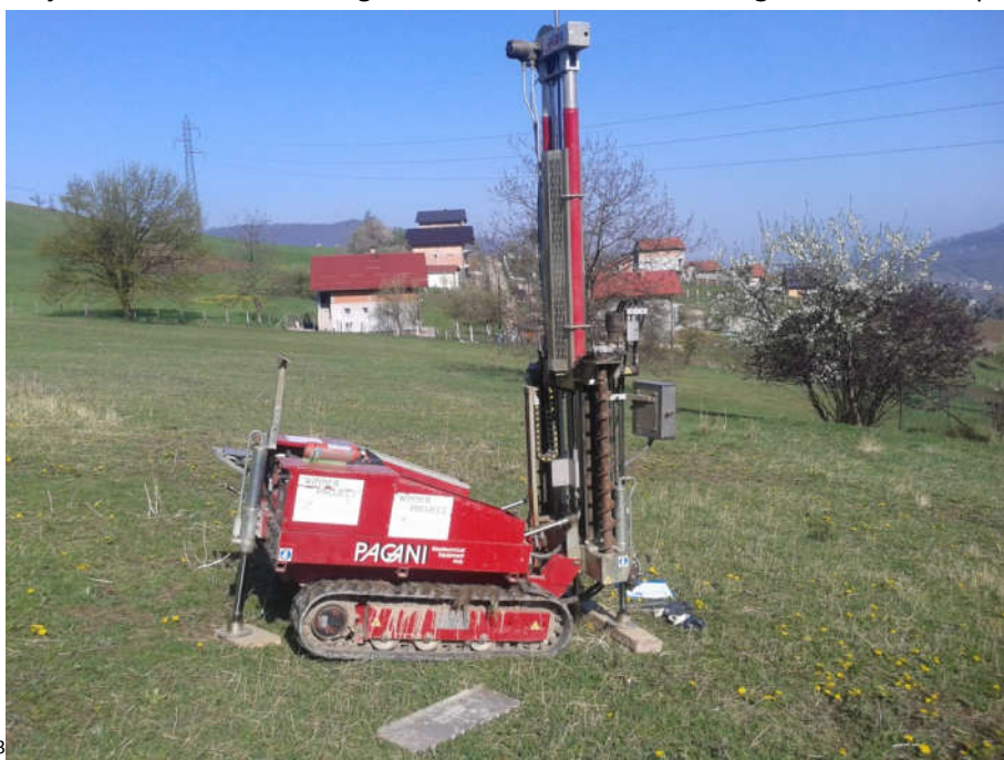
Slika 2. Izvođenja kontinuirane penetracije (DPSH)
